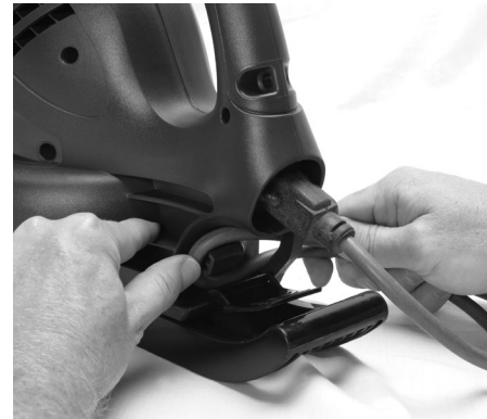
Figura 4-3: Hale el lazo del cordón de extensión apretándolo alrededor del enganche moldeado para el cordón
